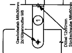
Der Befestigungspunkt einer Sprossenwand darf max. 1/5 unterhalb des höchsten Punktes bzw. der Oberkante angebracht werden. Innerhalb diesen Maßes ist die Anbringung beliebig. Dies gilt auch für die Anbringung der Befestigung von unten gesehen.
